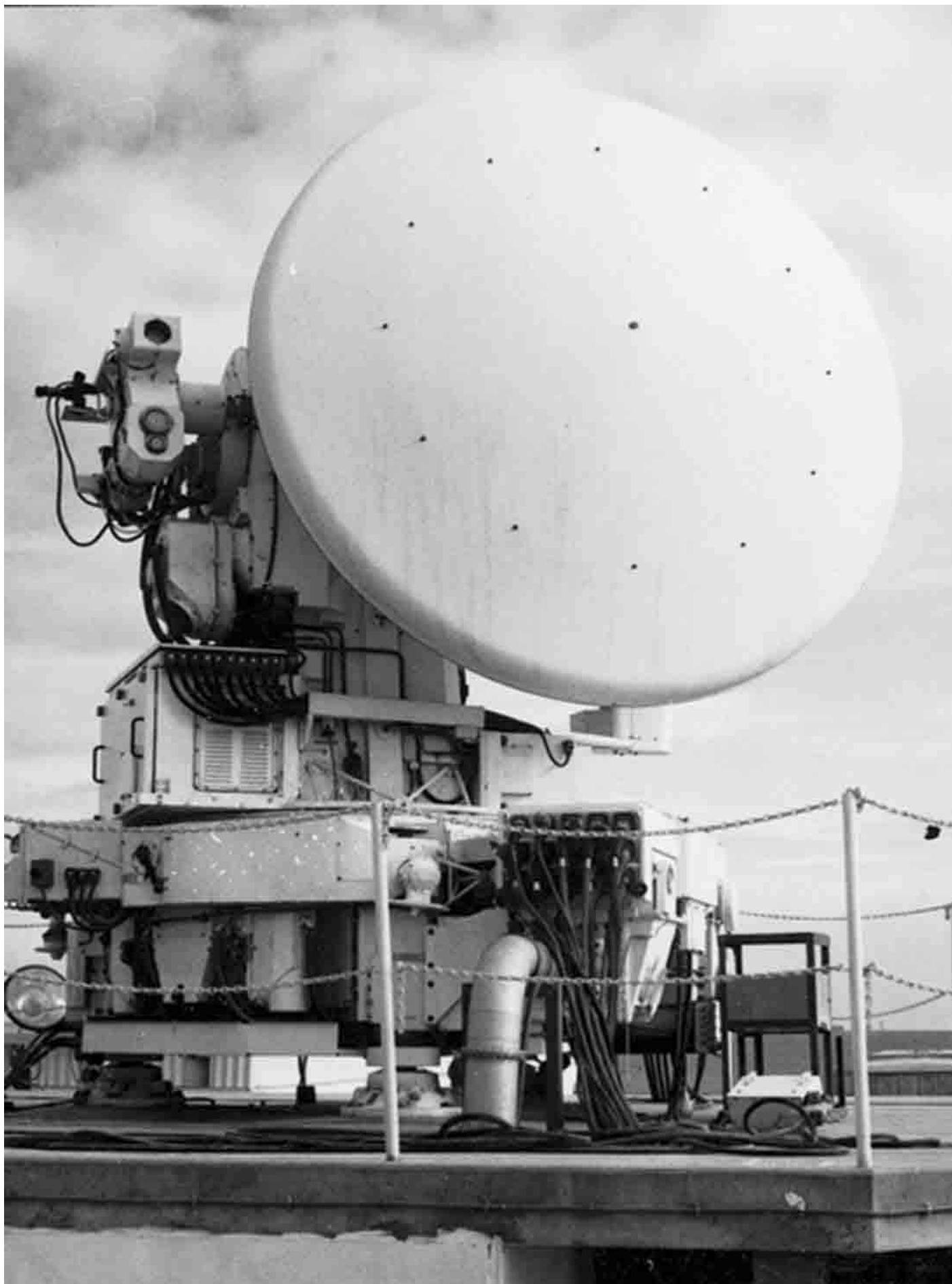
Radars de trajectographie Aquitaine capable de déterminer à 10 mètres près et à 0,1 millièmes de radian la position d'un satellite. Sa portée est de 3 000 kilomètres. Il est en relation avec les champs d'antennes AME
