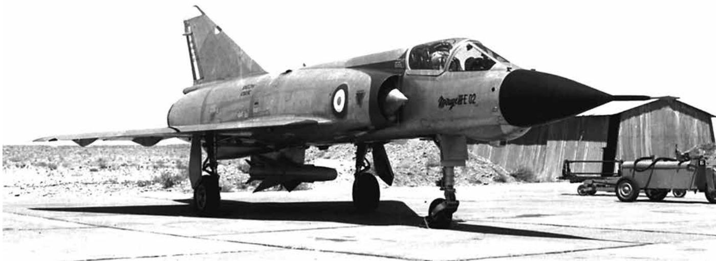
▲ Essai du missile air-air Matra 530 sur le Mirage III E n° 02
