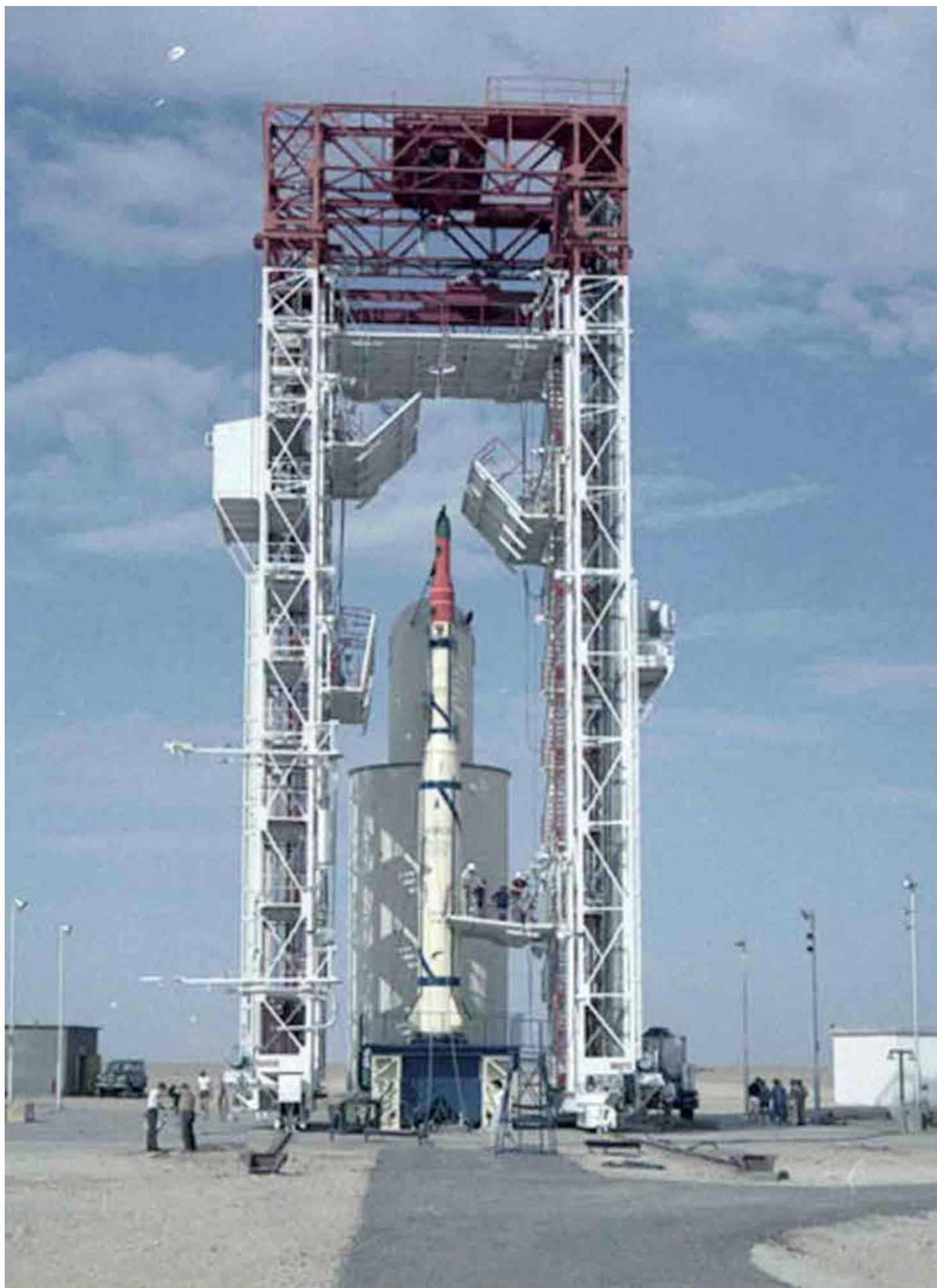
La fusée Emeraude a précédé la fusée Diamant dont elle est le premier étage, dans le programme Pierres Précieuses de juin 1964 à mai 1965, avec deux lancements réussis sur cinq
