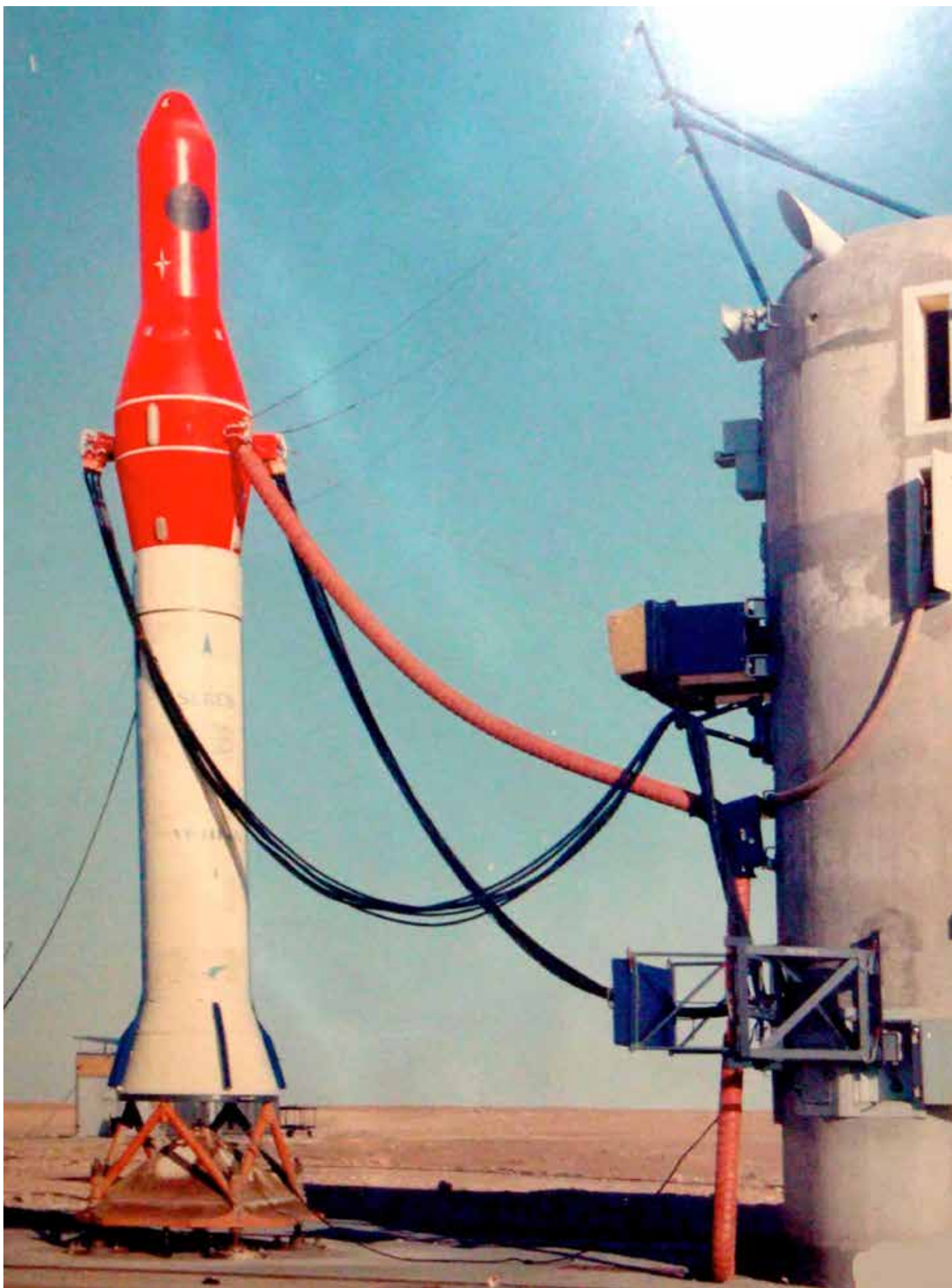
Mai 1965 - Véhicule d'essai 111LG, premier engin français guidé inertiuellement par une centrale SAGEM
