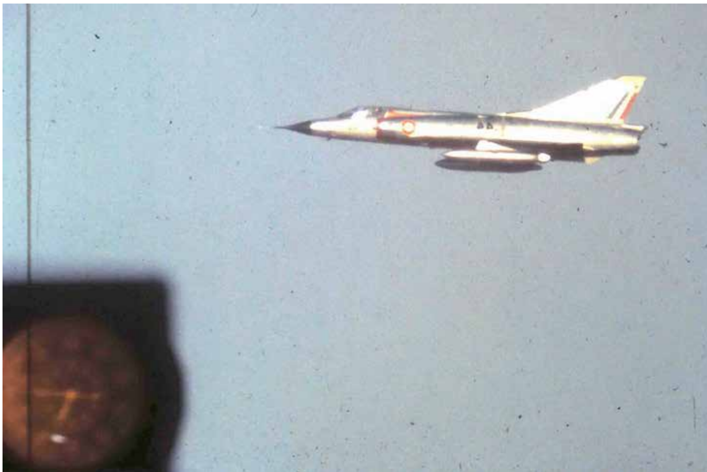
▲ Mirage III photographié à 30 000 pieds par un cinéthéodolithe, à gauche un chronomètre
